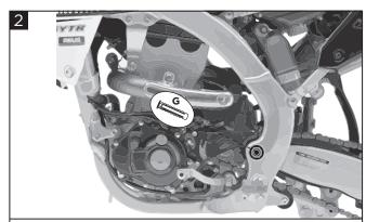
Introduce the expander (G) in the hole of the frame. Inserire l'expander (G) in plastica nel foro del telaio
